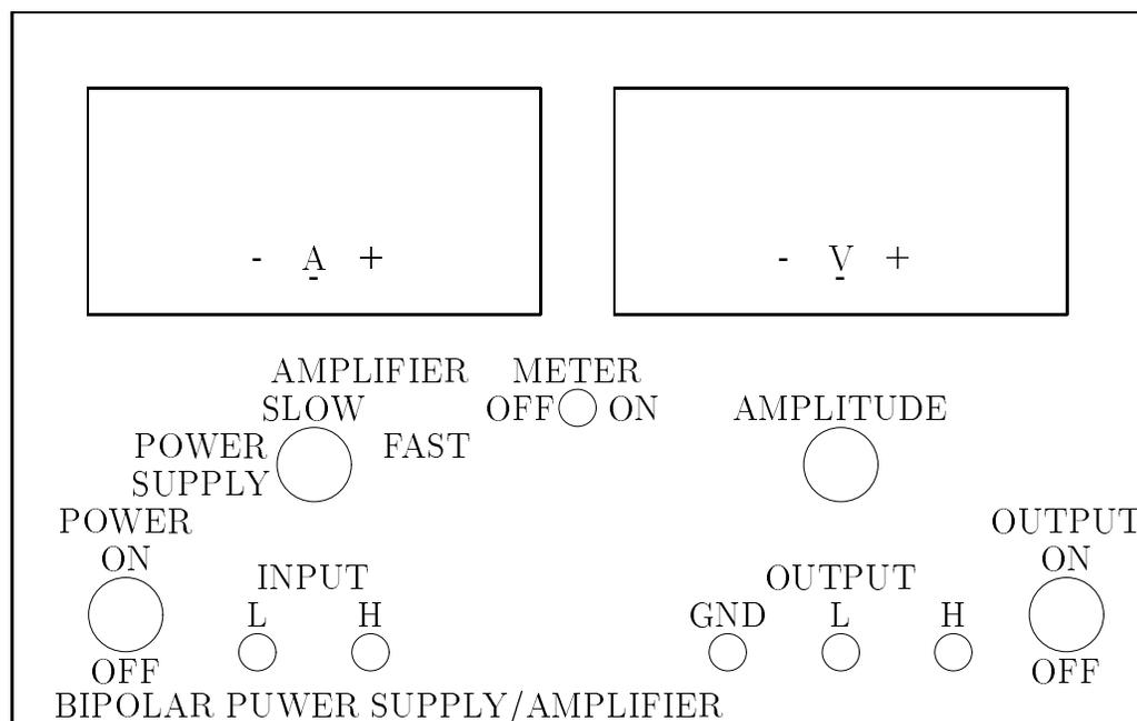
図 20.2: 両極性直流電源・増幅器
