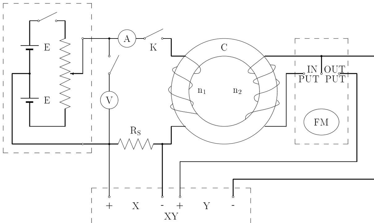
図 20.1: 磁束計による B-H 曲線の測定の結線図
